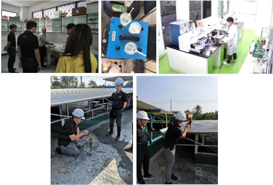
รูปที่ 4.37 การทดสอบปริมาณการใช้สารเคมีที่เหมาะสมในการบำบัดน้ำเสียของบริษัท เอส เอส ซี ออยล์ จำกัด ภายใต้การดำเนินโครงการ
