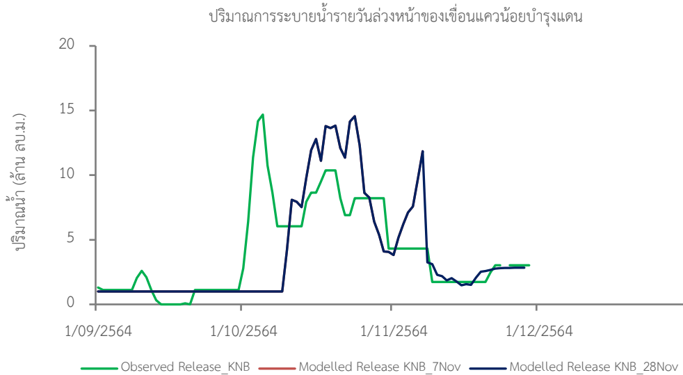
รูปผนวกที่ E-24 ผลการกำหนดปริมาณการระบายน้ำล้นหน้าของเขื่อนแควน้อยบำรุงแดนในช่วงพายุ เดือนพฤษภาคมด้วยแบบจำลองการโปรแกรมแบบข้อจำกัด
