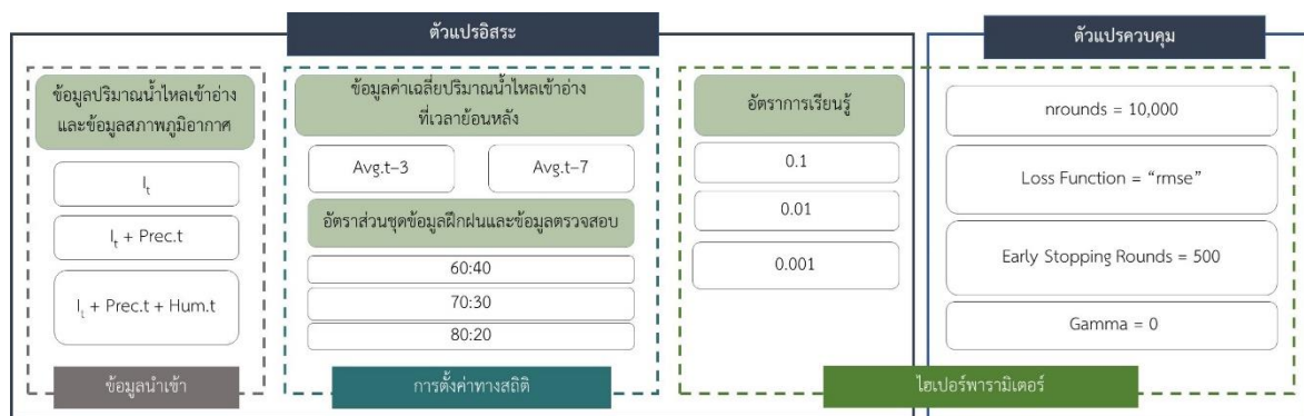
รูปที่ 4-42 กระบวนการทำงานในการพัฒนาแบบจำลองการพยากรณ์ข้อมูลปริมาณน้ำไหลเข้าอ่างเก็บน้ำแบบอ่างเดี่ยวด้วยอัลกอริทึม XGBoost ของเขื่อนภูมิพลและเขื่อนสิริกิติ์
