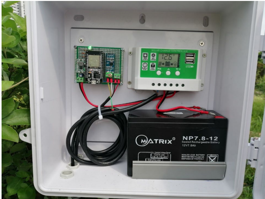
รูปที่ 3-49 การต่อวงจรโดยรวมของอุปกรณ์วัดความชื้นในดินแบบใช้แบตเตอรี่
