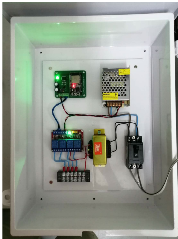
รูปที่ 3-55 การต่อวงจรภายในกล่องควบคุมชนิด 4 ช่อง เพื่อควบคุมวาล์วน้ำ (โซลินอยด์วาล์ว 24 VAC) ติดตั้งอยู่ในสวน 100 ปี
