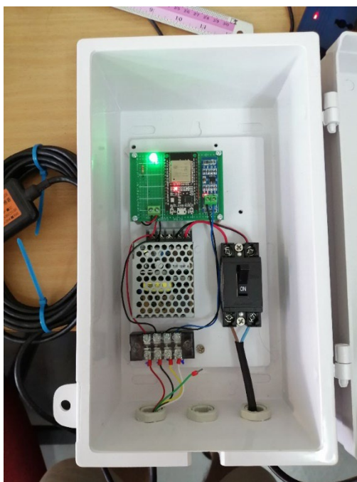
รูปที่ 3-50 การต่อวงจรโดยรวมของอุปกรณ์วัดความชื้นในดิน, วัดอุณหภูมิ และค่า EC
