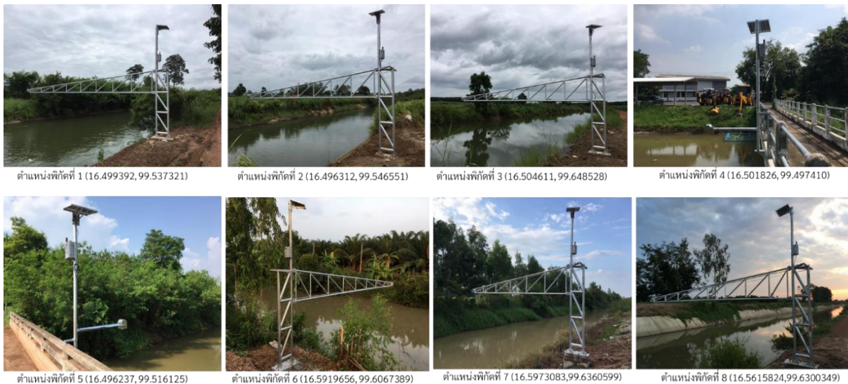
รูปที่ ก-3 อุปกรณ์ตรวจวัดระดับน้ำในพื้นที่เกษตรกรรม 8 จุด
