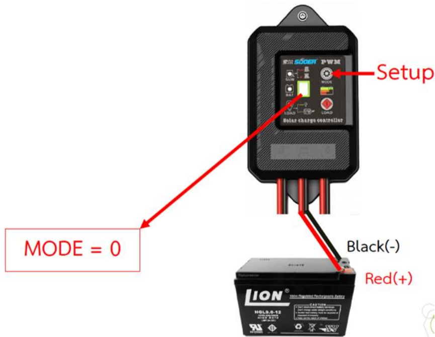
รูปที่ 5-4 การตั้งค่าการทำงานของเครื่องชาร์จโซล่าเซลล์
