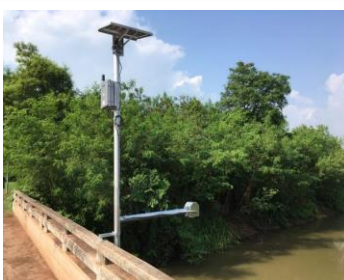
เครื่องมือวัดระดับน้ำในคลองสายหลัก
