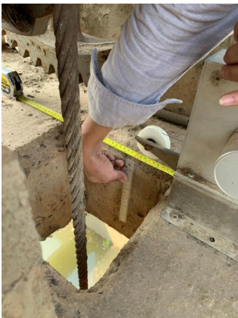
รูปที่ 4-23 การวัดผลหลัง Calibrate เซนเซอร์วัดระดับประตุน้ำ
