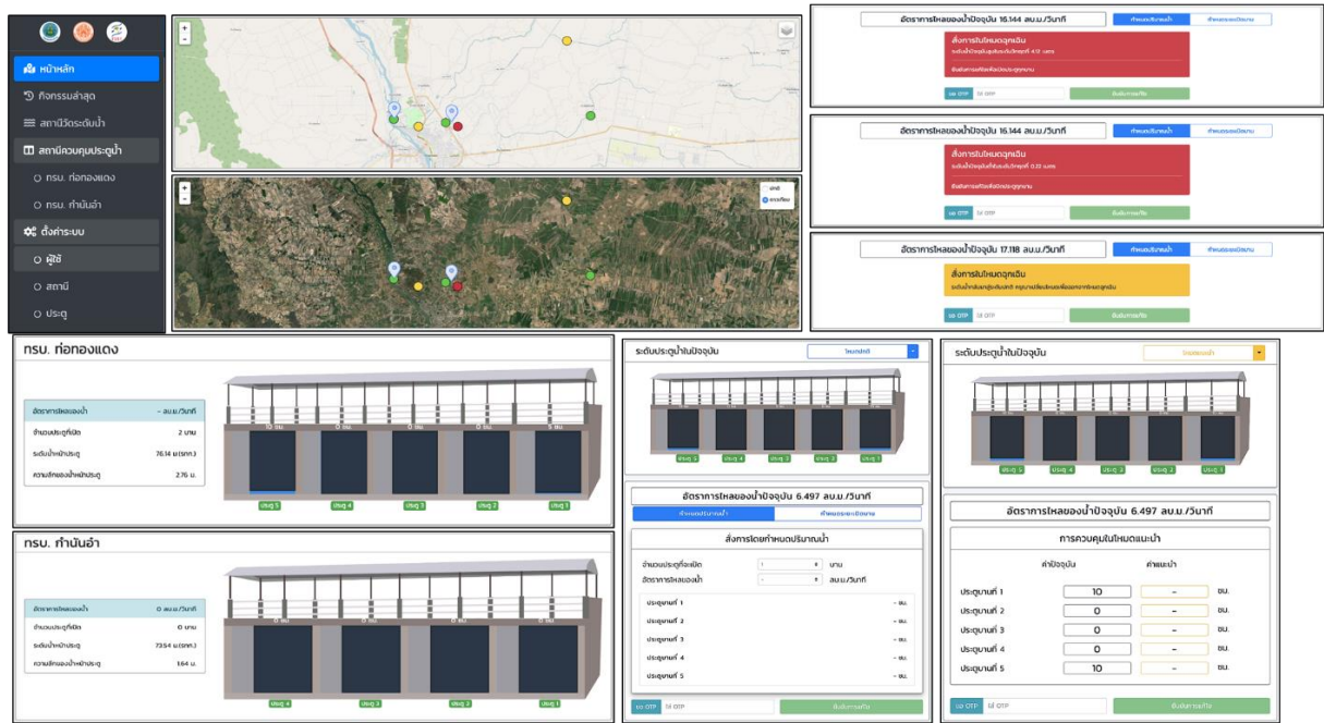
รูปที่ ก-8 หน้าต่างการควบคุมปริมาณการระบายน้ำจากอาคารบังคับน้ำ ทרב.ท่อทองแดง และทรบ.กำปงธำ
