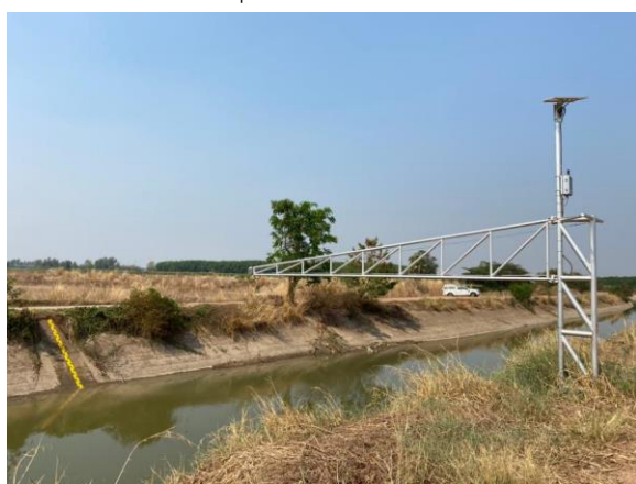
สถานีวัดระดับน้ำที่ 3 คลอง MC กม.23+800 และจุดติดตั้ง Staff gauge
