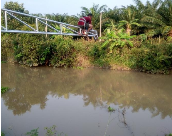
รูปที่ 4-13 การวัดระดับน้ำเพื่อการ Calibrate อุปกรณ์วัดระดับน้ำ
