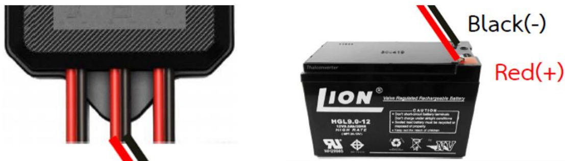
รูปที่ 5-3 ตำแหน่งการเชื่อมต่อสายฟ่วงแบตเตอรี่ เส้นสีแดงขั้วบวก (+) และเส้นสีดำขั้วลบ (-)
