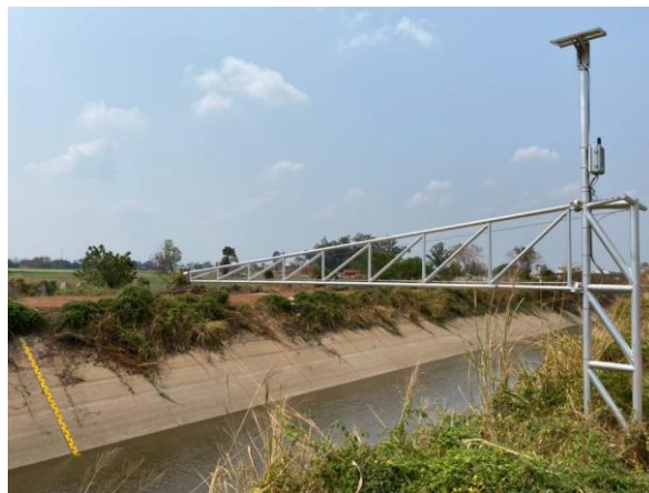
สถานีวัดระดับน้ำที่ 2 คลอง MC กม.6+236 และจุดติดตั้ง Staff gauge
