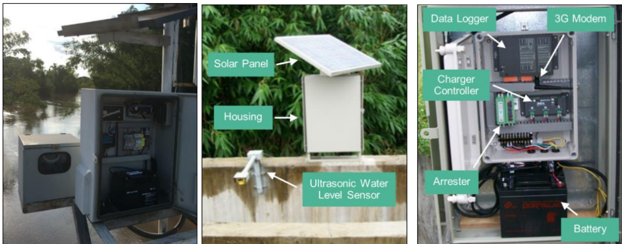
รูปที่ 4-5 เครื่องโทรมาตรวัดระดับน้ำในรูปแบบเก่า
