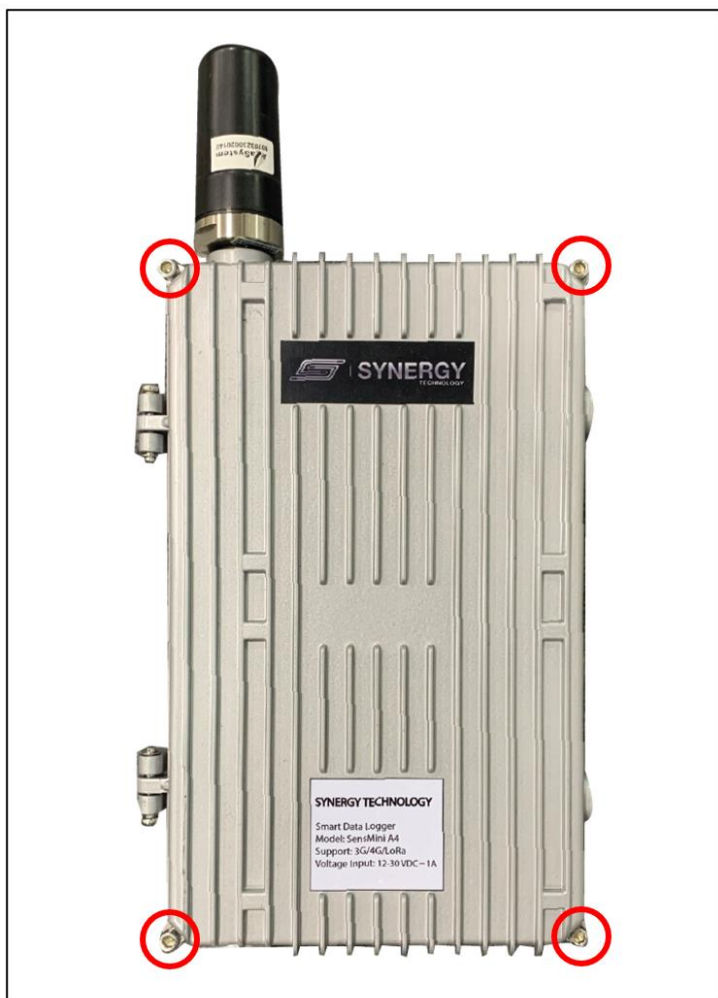
รูปที่ 4-2 ตำแหน่งน็อตสำหรับการปิดล็อคอุปกรณ์ SensMini A4-NB
