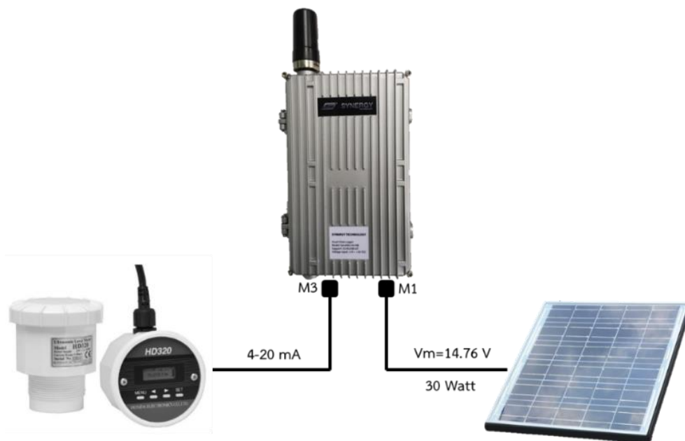
รูปที่ 4-9 การเชื่อมต่ออุปกรณ์บนสถานีวัดระดับน้ำ
