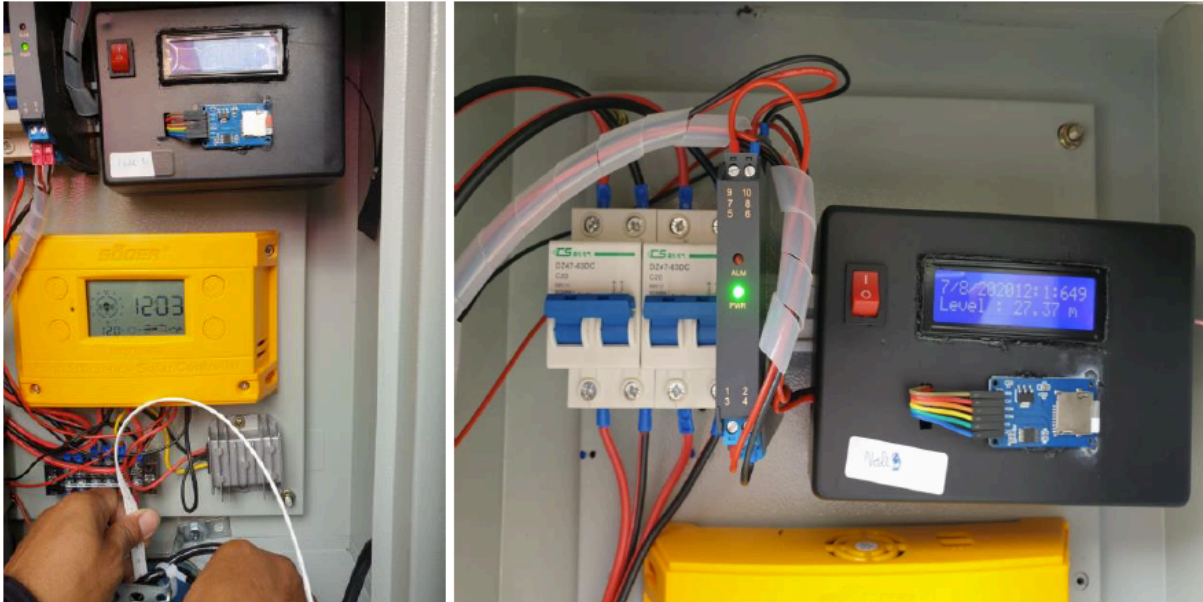
รูปที่ 8 การทดสอบความถูกต้องของการวัดระดับน้ำบาดาล
