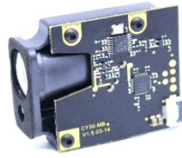
รูปที่ 6.3-1 เซนเซอร์วัดระยะทางแบบเลเซอร์ CY-30MB
