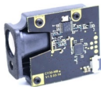
รูปที่ ง-1 เซนเซอร์วัดระยะทางแบบเลเซอร์ CY-30MB
