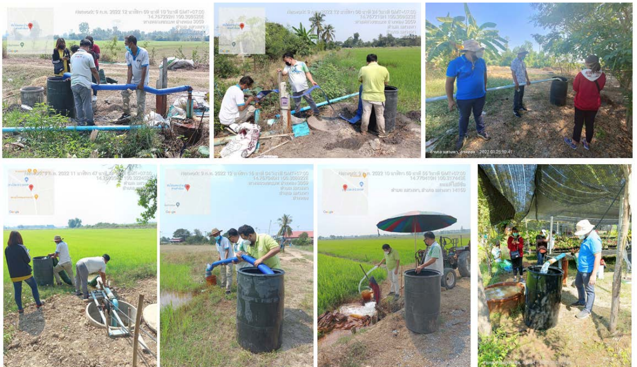
รูปที่ 6.1-5 การตรวจวัดอัตราการสูบน้ำบาดาล
