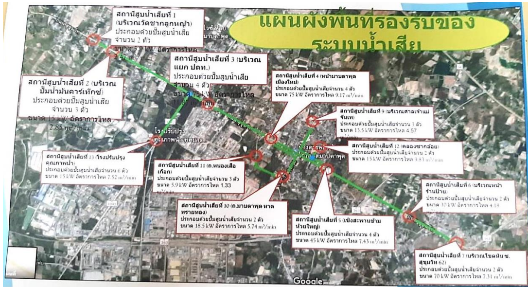
รูปที่ 2.80 ผังสถานีสูบน้ำที่รองรับน้ำเสียในพื้นที่ระบบบำบัดน้ำเสีย
