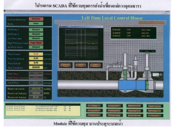
โปรแกรม SCADA ที่ใช้ควบคุมการส่งน้ำ
