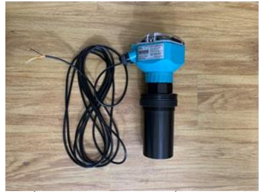
รูปที่ 3-3 การออกแบบระบบการทำงานของอุปกรณ์ตรวจวัดระดับน้ำ และ Sensor วัดระดับน้ำ
