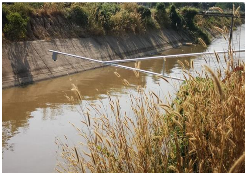
รูปที่ ค-5 เสาติดตั้งเซ็นเซอร์วัดระดับน้ำ และการใช้ลูกดิ่งเพื่อตรวจสอบความแม่นยำของเซ็นเซอร์
