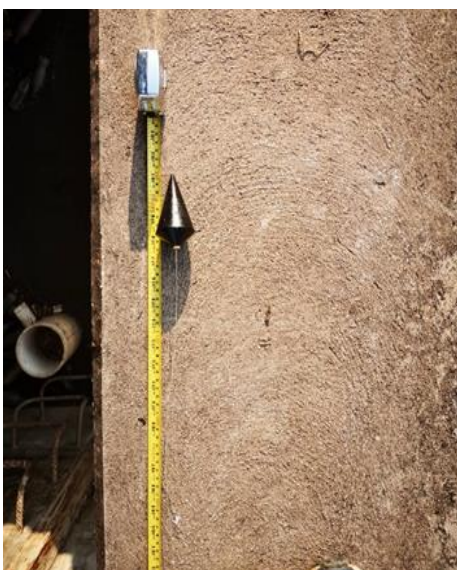
รูปที่ ค-5 เสาติดตั้งเซ็นเซอร์วัดระดับน้ำ และการใช้ลูกดิ่งเพื่อตรวจสอบความแม่นยำของเซ็นเซอร์
