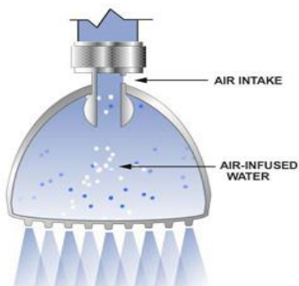
รูปที่ 4-12 ตัวอย่างเทคโนโลยีของอุปกรณ์ประหยัดน้ำประเภทต่างๆที่แสดงในตารางที่ 4-7 (a) Dual flush, (b) Siphonic, (c) Tap flow restrictor, (d) waterless urinal, (e) aerated showerhead, (f) programmed cloth washer
