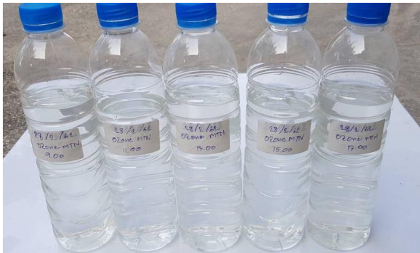
รูปที่ 4-75 แสดงสีของน้ำเสียจากส้วมที่ผ่านการบำบัดด้วยโอโซนในเดือนกุมภาพันธ์และมีนาคม 2562
