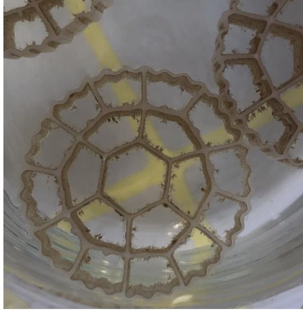
ภาพที่ 3.2.2-1 แบบที่เรียที่เกาะติดบนผิวตัวกลางด้านในที่ติดตั้งในระบบบำบัดน้ำเสียจริง MBBR
