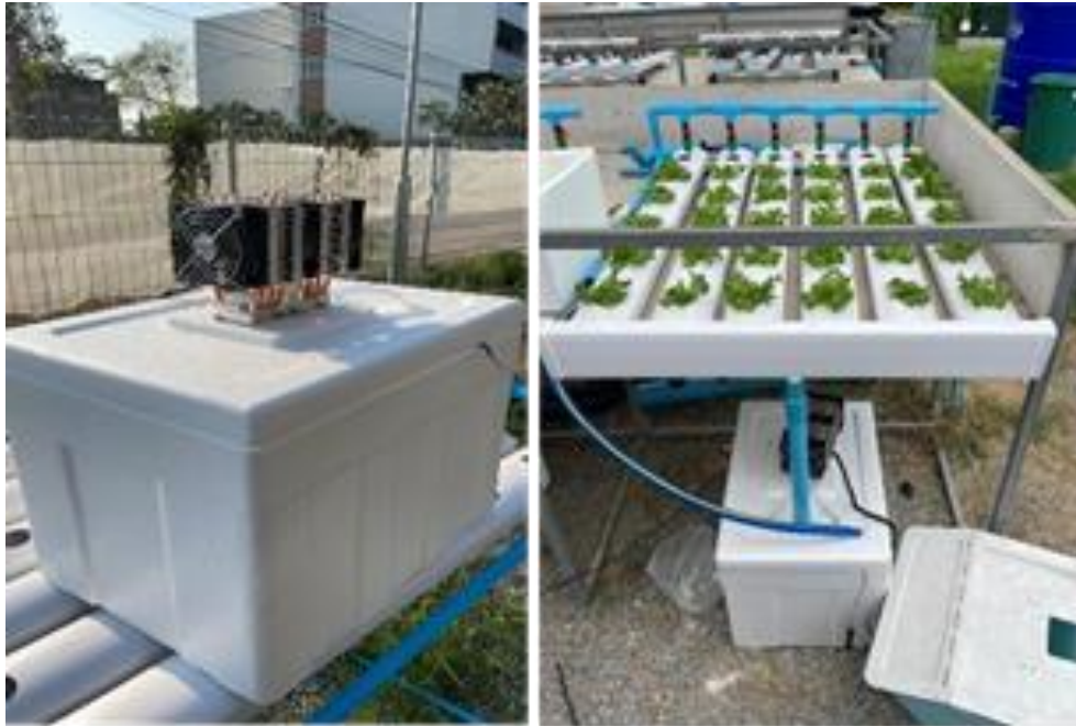
ชุดปลูกพืชไฮโดรโปนิคส์ที่มีการติดตั้งอุปกรณ์ควบคุมอุณหภูมิเพเลเทียร์
