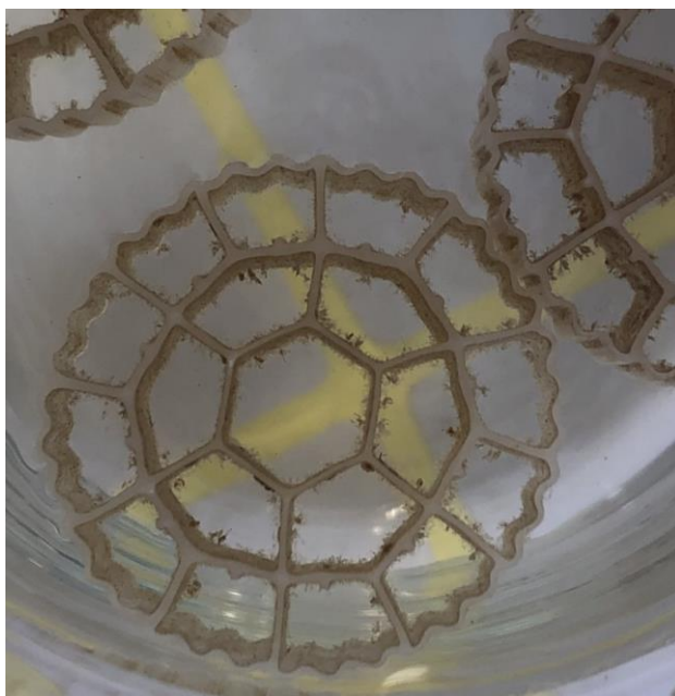
ภาพที่ 2.2.2-1 แบคทีเรียที่เกาะติดบนผิวตัวกลางด้านในที่ตั้งในระบบบำบัดน้ำเสียจริง MBBR
