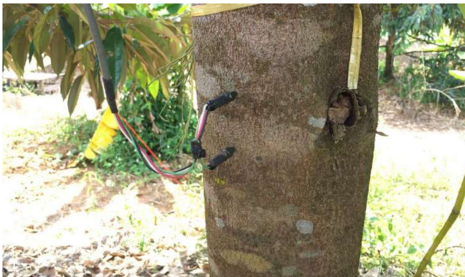
รูปที่ 3-9 การติดตั้งเซนเซอร์ลงในเนื้อไม้
