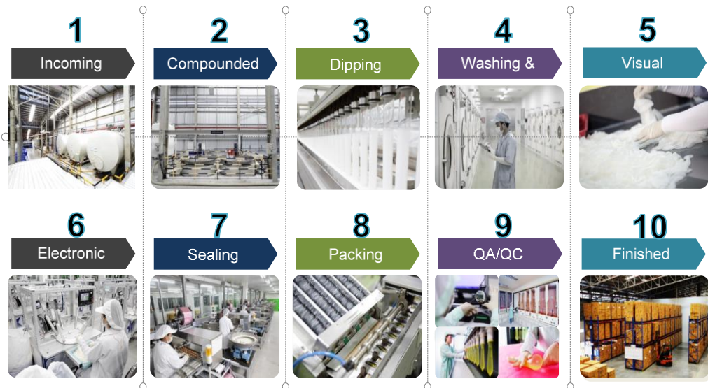
รูปที่ 3-55 แผนผังกระบวนการผลิตของบริษัท ไทยนิปอนรับเบอร์อินดัสตรี จำกัด (มหาชน)
