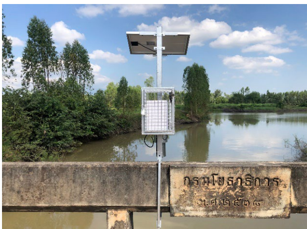
รูปที่ 4 ระบบติดตามระดับน้ำในคลองส่งน้ำสายหลักและสายซอย
