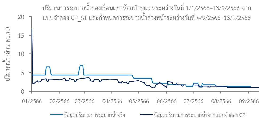
ภาพที่ 4-51 ปริมาณการระบายน้ำของเขื่อนแควน้อยบำรุงแดนระหว่างวันที่ 1/1/2566-13/9/2566 จากแบบจำลอง CP_S1
